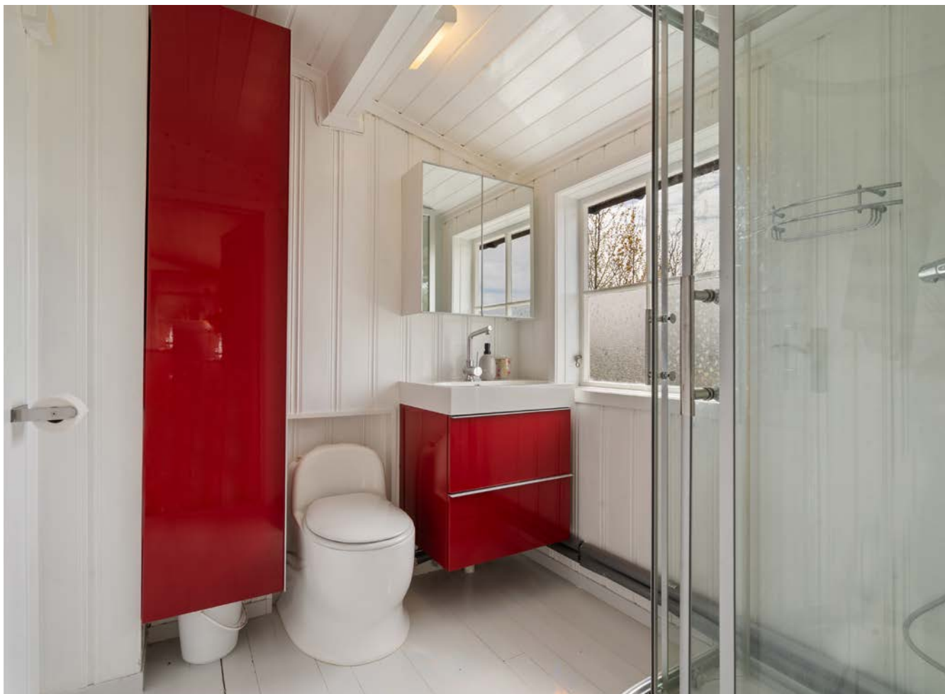
Bad med snurredo med fire kammer og barkkompostering. Tilnærmet luktfri med lufting med vifte ut på tak. Dusjkabinett.
