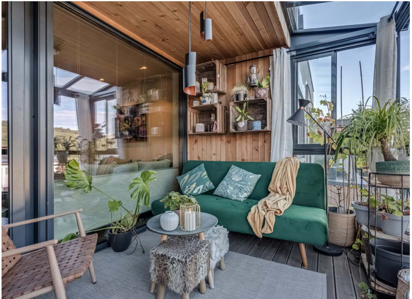
Innglasset balkong/hagestue med terrassebord og fasade i glass/aluminium. Overbygg i treverk/glass.
