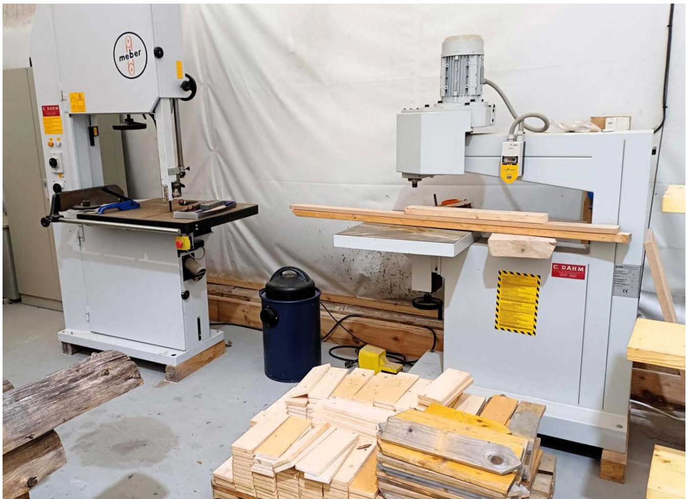
Vertikal båndsgag til venstre og vertikal overfres (ubrukt) til høyre og en liten flissuger i midten.
