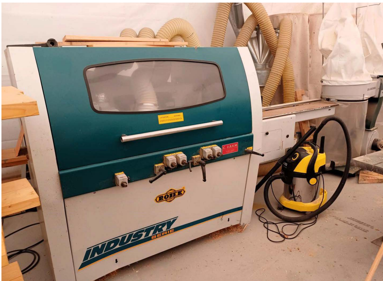
Rojek 4 kutter høvelmaskin. Høvler og/eller profilerer fire sider på en plank samtidig
