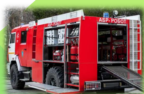
АБР-РОБОТ с выдвинутым трапом для погрузки (разгрузки) МРК – РП
