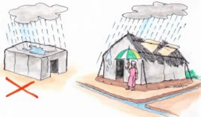
Construire les abris en pente afin que l'eau coule aisément.
