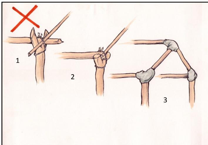
Eviter de construire des charpentes pointues pour trouver les bâches permettra aux toitures de durer plus longtemps.
