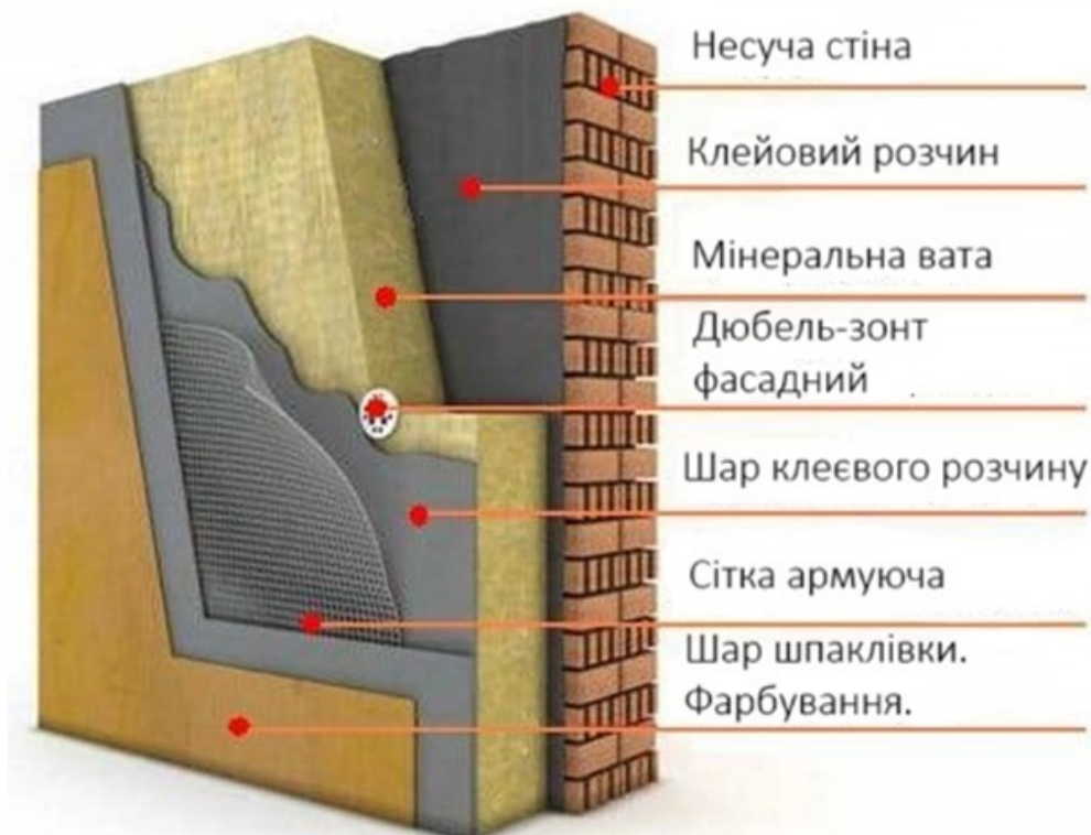
Схематичний вузол утеплення фасаду
