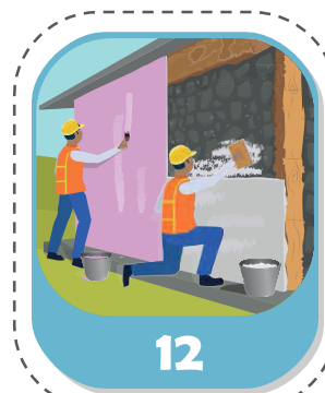
Crepissage et enduissage: même mélange de mortier pour la finition des murs
