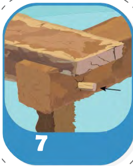
Connexion poutre-poteau: entaille et cheville
