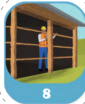
Installez un nouveau poteau de bois horizontal de 100x50 mm entre les poteaux verticaux et espacés à 60 cm max
