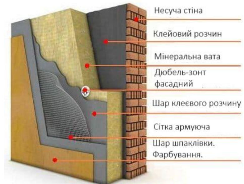
Вузол утеплення фасаду мінеральною ватою:
