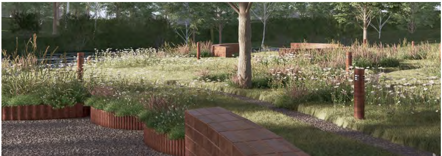
Planteringslådor i corten, låga murar av tegel för avgränsning, sittplatser och lek, stig med aggregat av krossade betongplattor från platsen.
